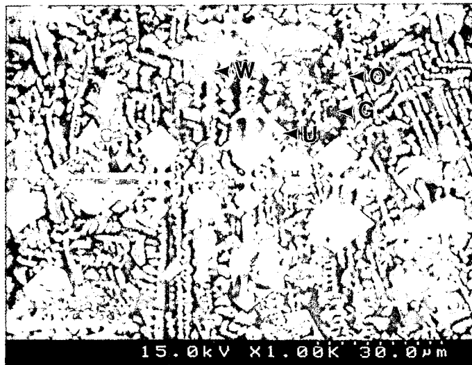
그림 2. 슬래그 B에 존재하는 석출상으로 U : ulvospinel, W : wustite,
