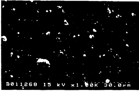
그림 2. 선행오손시킨 실리콘 고무표면의 시간경과에 따른 SEM 사진
