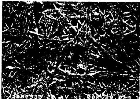
그림 5 CIP 성형과 저산소 분위기, 835°C에서 80 시간 열처리를 반복한 Bi2223 시료에서의 SEM 조직 (위:1회, 아래 :2회)
