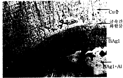
그림 7 brazing 계면의 현미경 조직 사진
