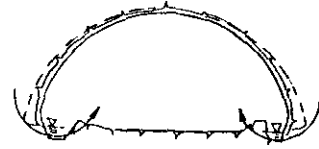
그림 7. 공사중 배수구에 의한 침하
