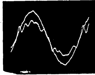
그림 12. 전원전류와 전원전압 (u상) ( I_{uo}: 2A/div, V_{uo}: 20V/div, T: 2ms/div )
