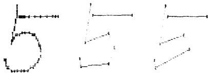
(a)원 데이터 (b)처리후 결과 (c)처리후 결과 (b)Dmin=10pixels, Cmax=5, \theta_{min}=\pi/5rad , Ddeh=3pixels (c)Dmin=10pixels, Cmax=5, \theta_{min}=\pi/3rad , Ddeh=3pixels 그림 6. \theta_{min} 값에 따른 결과의 차이
