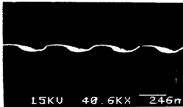
(사진) 현상 후에 형성된 포토레지스트 격자의 SEM 사진
