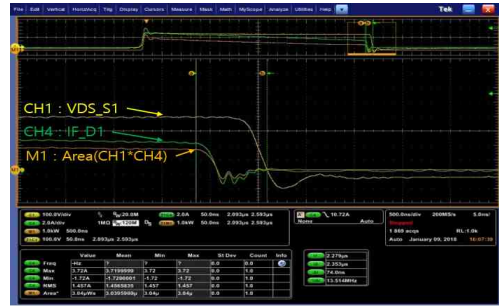
그림 11. 시작품에 적용된 SiC SBD의 스위칭 턴 온 손실 (500ns/div) Fig. 11. Switching turn-on losses of SiC SBD applied to the prototype(500ns/div)
