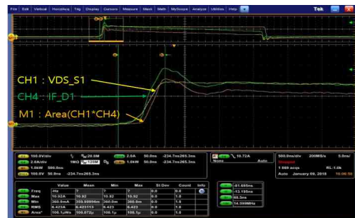
그림 12. 시작품에 적용된 SiC SBD의 스위칭 턴 오프 손실 (500ns/div) Fig. 12. Switching turn-off losses of SiC SBD applied to the prototype(500ns/div)
