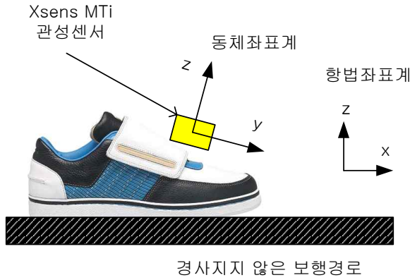
그림 1. 신발에 설치된 관성센서. Fig. 1. An inertial sensor unit installed on a shoe.
