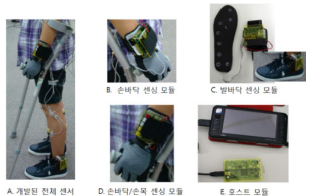
그림 2. 재활로봇 ROBIN의 센서. Fig. 2. Sensors of rehabilitation robot, ROBIN.
