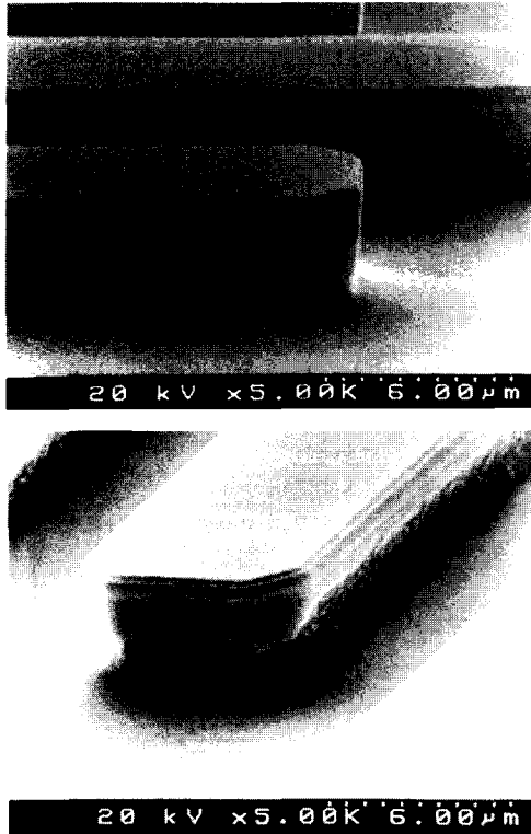
그림 4. 5BCl 3 /15Ne 플라즈마를 이용하여 식각한 GaAs (위) 와 AlGaAs (아래) 의 SEM 사진.
