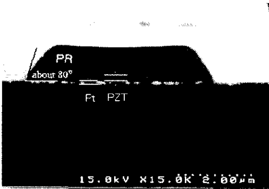
그림 5. Ar/BCl 3 조건과 기판온도 80 ℃에서 식각된 PZT 박막의 SEM 단면사진 Fig. 5. Cross-sectional SEM micrograph of etched PZT thin film in condition of Ar/BCl 3 gas mixing and 80 ℃ of substrate temperature
